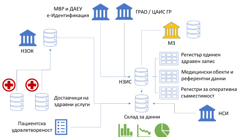
Фигура 26: Информационни потоци и свързаност на трета стъпка от аналитичния модел; забележка: показани са само интеграциите, необходими за осъществяване на аналитичната функция
